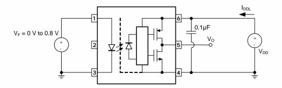
Figure 26. I<sub>DDL</sub> Test Circuit
